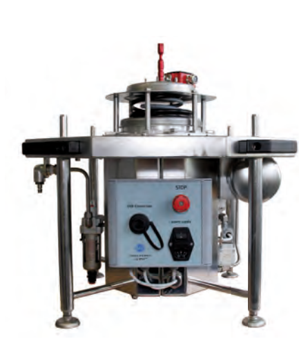
Испытательный стенд MPreC с установленным клапаном сброса давления
